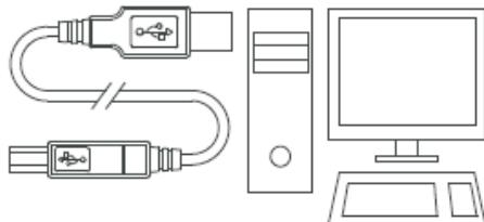
Zum Programmieren der Datenlogger wird ein passendes Interface (Schreib-Lesegerät, als Zubehör lieferbar) benötigt. Dieses Interface wird über den Universal Serial Bus (USB, spezielles Kabel als Zubehör lieferbar) mit dem PC verbunden und von dort mit Strom versorgt.
