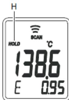
Die LCD-Anzeige zeigt die momentane Temperatur in Grad Celsius oder Grad Fahrenheit an. Nach Loslassen der Messtaste (7) wird der Messwert weitere 60 Sekunden lang angezeigt; dabei wird das Wort HOLD (H) eingeblendet. Dann schaltet sich das Gerät selbsttätig ab.
