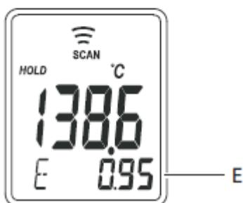
Die meisten im Lebensmittelbereich auftretenden Produkte (einschließlich Wasser, anderer Flüssigkeiten und in Kartons oder Plastikbehältern verpackter Lebensmittel) haben einen Emissionsgrad um 0,95. Das Gerät ist deshalb auf 0,95 voreingestellt.
