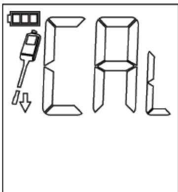
Die Justierung ist im frischen noch nicht gebrauchten Frittieröl durchzuführen und muss bei einer Öltemperatur von 150 °C bis 190 °C durchgeführt werden.
